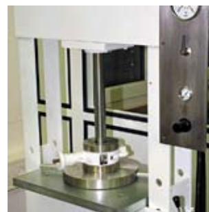
Испытание на герметичность высокочистым азотом
